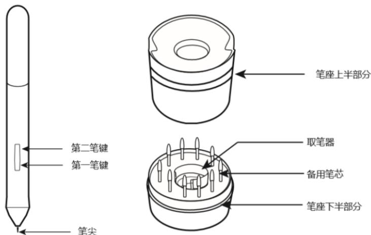
图 2-1.压感笔及笔座结构示意图
