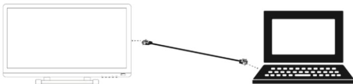
图 3-2-3.VGA 线连接
